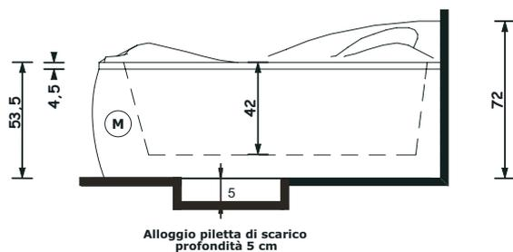
Motore Idromassaggio (M) Whirlpool Motor
